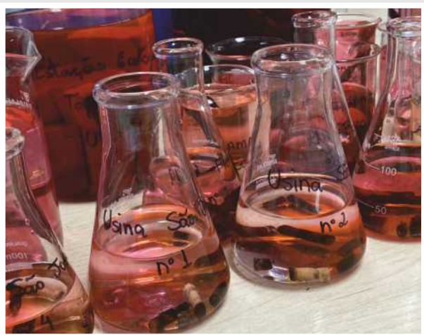
Coleta de amostras do cerne para análise científica da madeira quanto à densidade, resistência e outros fatores. Fotos: Juliana Neves
